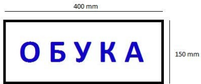
Прилог број 10 ДИМЕНЗИЈЕ И ИЗГЛЕД ТАБЛЕ ЗА ОЗНАЧАВАЊЕ ВОЗИЛА АУТОШКОЛЕ
