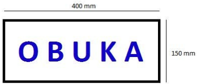
Prilog broj 10 DIMENZIJE I IZGLED TABLE ZA OZNAČAVANJE VOZILA AUTOŠKOLE
